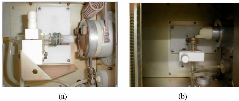
FIGURA 2.1 – Esquema mostrando a interface dos equipamentos com configuração: a) axial e b) radial.
