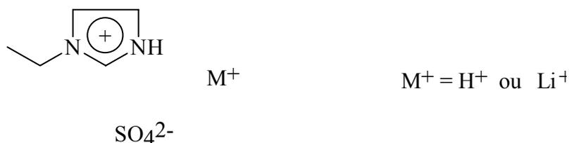
**Figura 2.13: Nova classe de líquidos iônicos com cátions de metal alcalino incorporados.**
