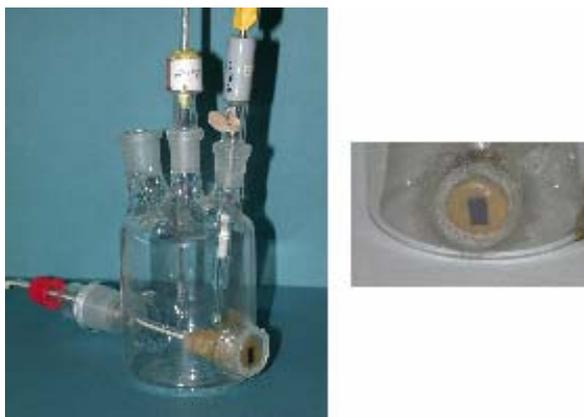
FIGURA 2.6: Célula eletroquímica usada nas medidas de fotocorrente. No detalhe o eletrodo de aço parcialmente recoberto com cera de abelha próximo à janela de quartzo.
