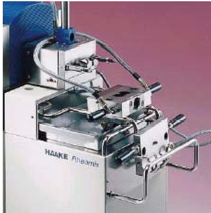
Figura 3.4: Detalhe da câmara de mistura do reômetro de Torque marca HAAKE [46].
