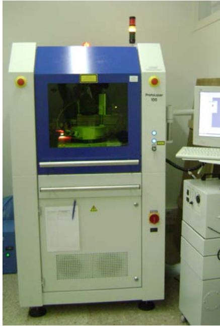
FIGURA 3.6. Equipamento a laser utilizado para o corte das cerâmicas verdes.
