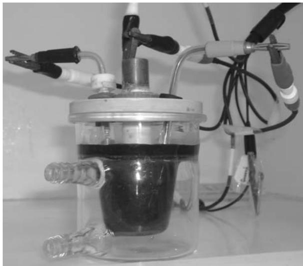
FIGURA 3.2: Célula eletroquímica.
