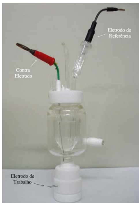
FIGURA 2.1: Foto da célula eletroquímica utilizada nas medidas eletroquímicas e de MECQ.
