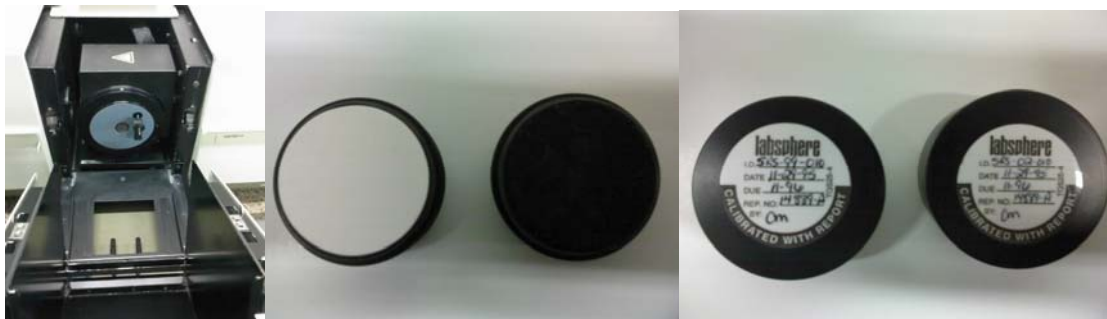
FIGURA 4.8.1: Esfera de integração e padrões de máxima e mínima refletância da Labsphere.
