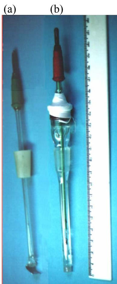
FIGURA 2.4: (a) Contra-Eletrodo de Platina e (b) Eletrodo de Calomelano Saturado utilizado como de referência.
