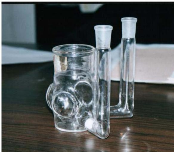
FIGURA 2.7: Célula eletroquímica utilizada nos estudos de PCS.
