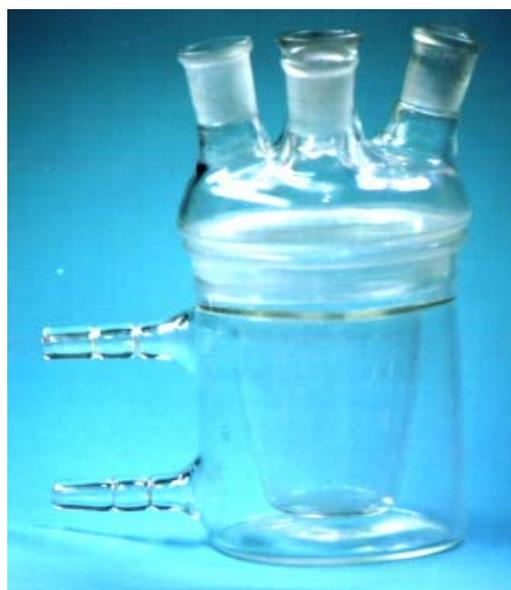
FIGURA 2.3: Célula eletroquímica utilizada, em cuja tampa encontram-se adaptadores para os eletrodos de trabalho, contra e referência.
