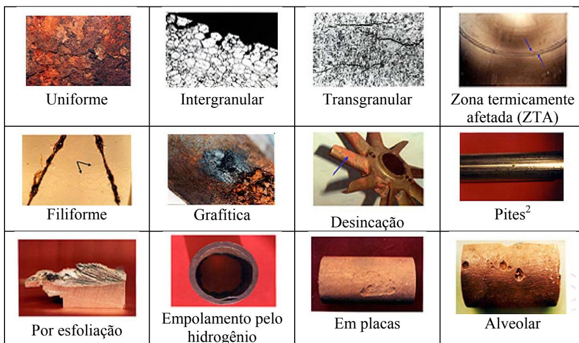
FIGURA 1.1: Classificação do processo de corrosão segundo o tipo do ataque [7].
