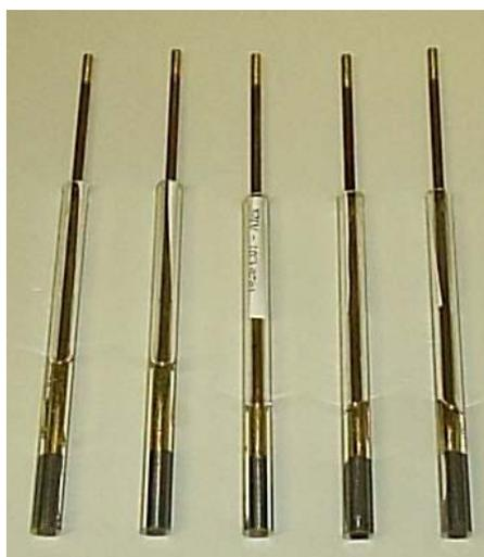
FIGURA 3.1: Fotografia do eletrodo de trabalho utilizado embutido em resina.
