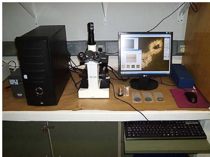
**FIGURA 3.10: Microscópio óptico invertido marca Opton - mod. TNM-07T-PL, com sistema digital de captura e processamento de imagem fotografadas ou filmadas.**
