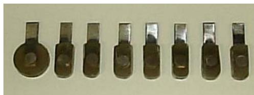
FIGURA 3.3: Foto do eletrodo de aço carbono 1020 e 1040, construído nos molde do suporte para medidas de DRX.
