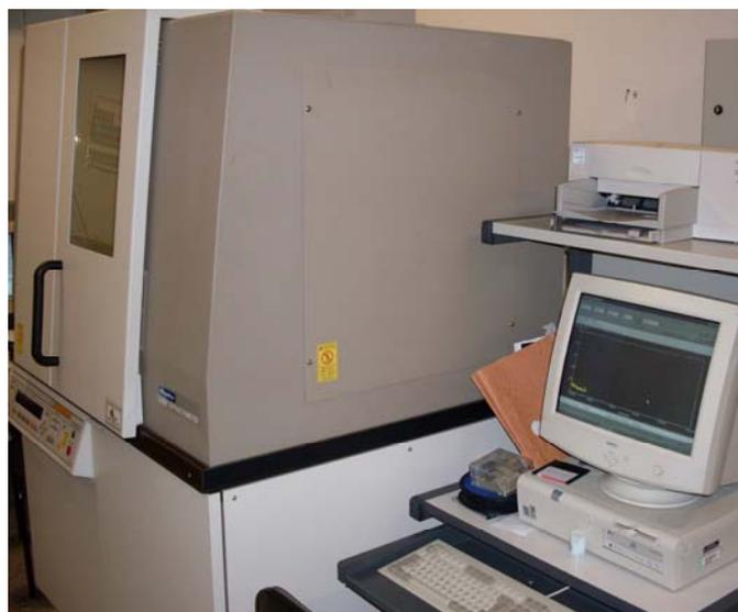
**FIGURA 3.9: Equipamento de DRX, marca Rigaku - mod. D-MAX 2500PC.**
