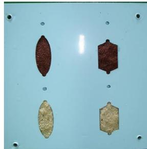
Figura 4.15. Geometrias das cavidades presentes no interior do dispositivo LTCC.
