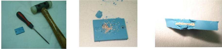
Figura 4.14. Zeólita natural no interior do dispositivo LTCC quebrado após etapa de sinterização.
