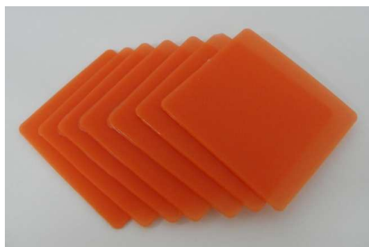
FIGURA 3.11.1 - Placas poliméricas obtidas após a mistura com pigmentos apropriados.
