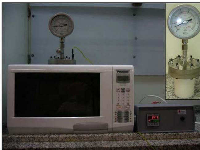
**Figura 4.2** - *Representação esquemática do sistema de hidrotermal de micro-ondas utilizado na preparação dos materiais sintetizados.*
