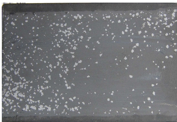
FIGURA 3.34 – Superfície do anodo de Nb/DDB após eletrólise do efluente têxtil real na presença de NaCl a 55 °C.
