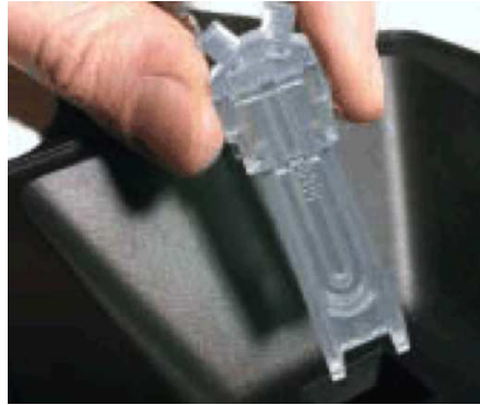
FIGURA 2.4 – Cubeta utilizada nos ensaios para a determinação do potencial zeta (Disponível em http://www.malvern.com/common/downloads/MRK496.pdf . Acessado em 20/01/2010).
