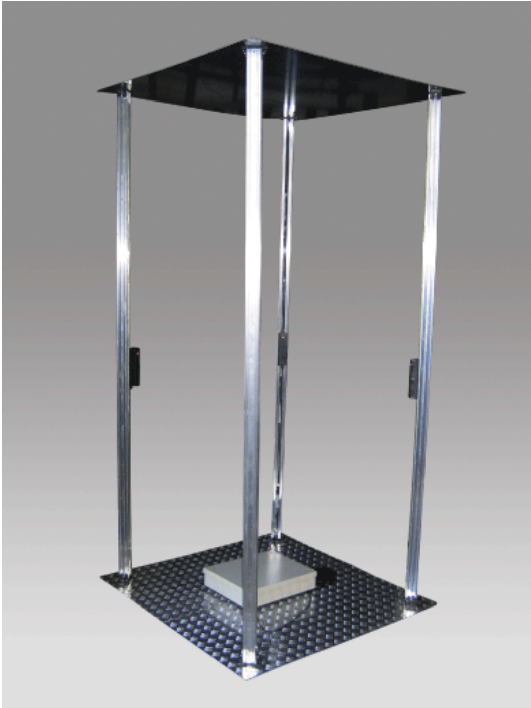
Figura 6.11: Montagem completa da cabine de varredura.
