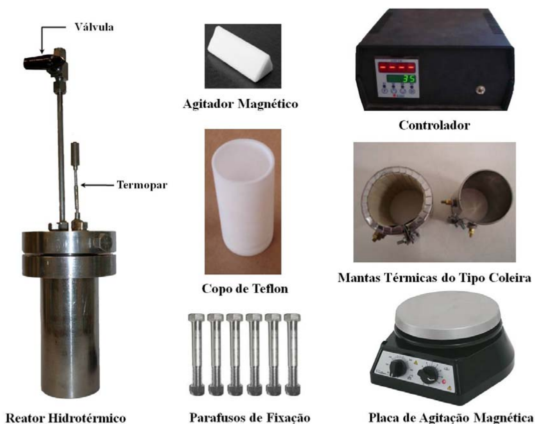
FIGURA 3.4 - Fotos do SHC e seus principais componentes.
