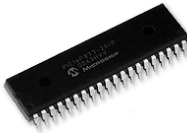
Figura 1. 9. Imagem de um PIC 16F877A
