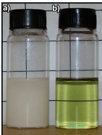
Figura 5. 1: Fotografia dos líquidos coletados após processamento da solução precursora da síntese de \text{TiO}_2 a 250^\circ\text{C} /1 h em microondas. a) Processamento com o frasco reacional vedado – Suspensão floculada; b) Processamento com o frasco reacional permitindo a eliminação de vapores – Solução estável.
