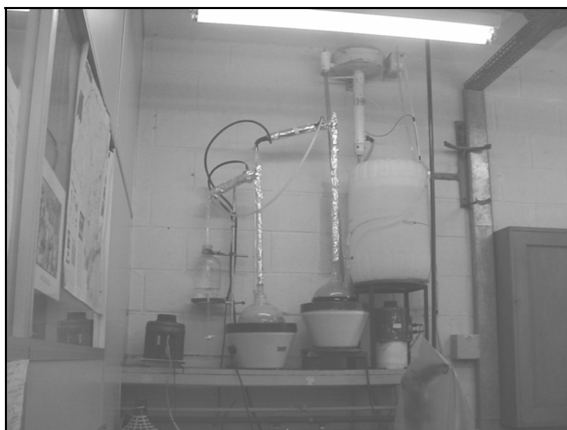
FOTO 4.3: Sistema de destilação e purificação da água com etapa em permanganato de potássio em meio alcalino, no primeiro balão de fundo redondo e somente água destilada e condensada do primeiro no segundo balão de fundo redondo com coletor ao final do sistema (da direita para a esquerda).
