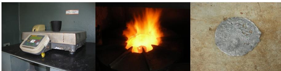
Figura 23- Balança e cadinho, planta piloto industrial e amostra de Pb metálico típica obtida nos testes industriais.
