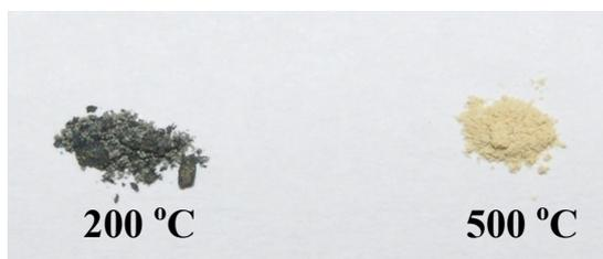
Figura 26- Amostras de mistura de 0,500g formadas por 33,3% de PbO, 22,2% de Na<sub>2</sub>CO<sub>3</sub> e 45% de C tratadas termicamente por 24 h em 200 °C e 500 °C.
