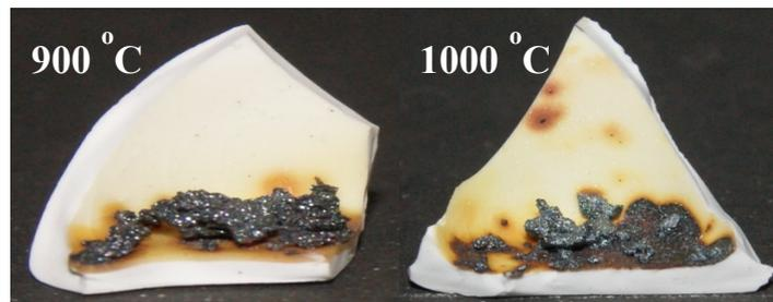
Figura 59- Amostras de mistura de 0,500g formadas por 75%  $\text{PbSO}_4$  e 25% Fe tratadas termicamente por 24 h em 900 °C e 1000 °C.
