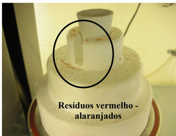
Figura 13- Resíduos vermelho-alaranjados do PbO depositados no suporte da mini planta-piloto após processamento térmico deste óxido em 1100° C por 24 h sem a passagem de gás na câmara da mini planta-piloto.
