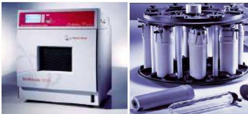
FIGURA 2.1 – Forno de micro-ondas comercial e frascos de quartzo utilizados para decomposição das amostras empregando sistemas fechados e pressurizados (Adaptado de PEREIRA, 2007).
