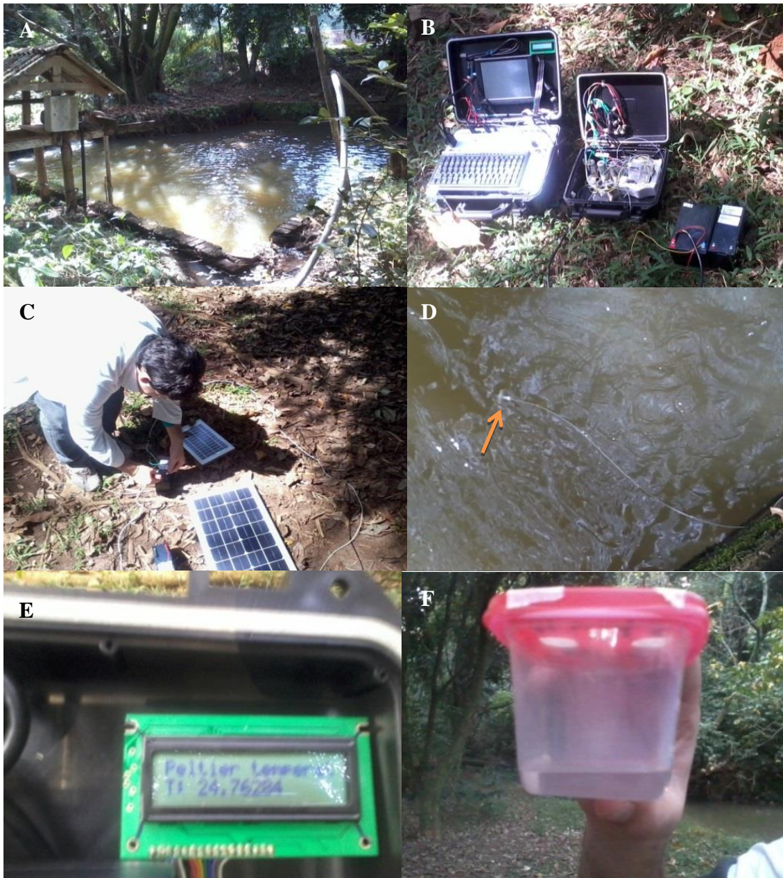
FIGURA 6.35. Análises em campo empregando o PG004. Em (A) têm-se o local de análise, em (B) fotografia do PG004 com o módulo de fluxo, e baterias alternativas (C) sendo recarregadas empregando-se as placas solares. Em (D) filtro de 0,45 \mu\text{m} acoplado ao sistema em fluxo para a captação das amostras superficiais de águas e filtração on-line . Medida da temperatura das amostras (E). Frasco de descarte (F) com 30 mL de resíduo gerado após 14 determinações (10 mL), inclusos os volumes devido aos procedimentos de limpeza (20 mL).
