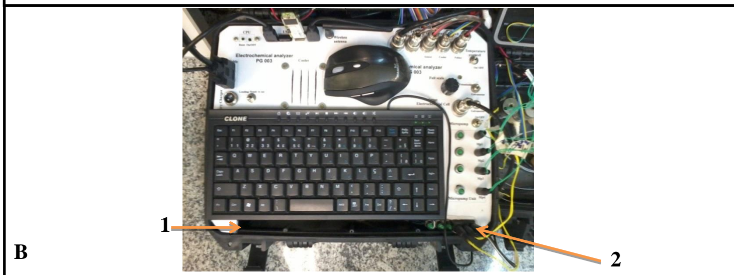
FIGURA 6.18. Desenho do painel frontal do PG004 com a distribuição e indicações dos controles e conexões de cada unidade (A). Fotografia com os conectores acoplados em suas respectivas localizações (B). 1: área reservada para introdução do teclado e 2: conectores das válvulas e agitador.
