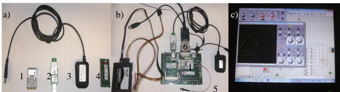
FIGURA 6.8. Periféricos acoplados a CPU. Em a) têm-se 1 = Placa de comunicação Wi-Fi® e Bluetooth® integrada em slot mini-PCI; 2 = modem 3G; 3 = GPS, 4 memória Kingston de 1 GB. Em b) têm-se cada periférico em “a”) acoplado a CPU, com exceção de 5 = antena wireless e 6 saída VGA para o monitor de LCD de 8’. Em c) tem-se o monitor com tela de LCD com touchscreen .
