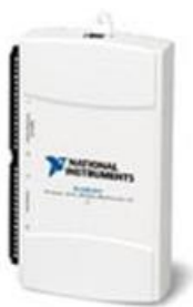
FIGURA 6.6. Fotografia da interface USB-6211 da NI ® utilizada no PG004.
