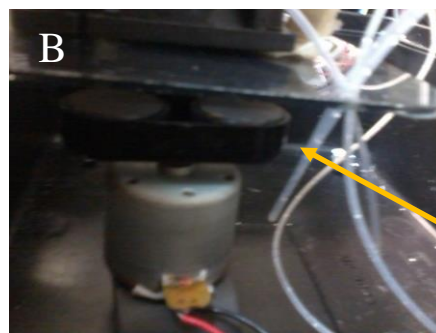
FIGURA 4.4. Fotografia ampliada da EFC com indicação da barra magnética inserida (A). Em (B) tem-se o agitador magnético, composto por um motor de 12 Vcc e dois ímãs acoplados, alocado abaixo da EFC para promover a agitação mecânica das soluções.
