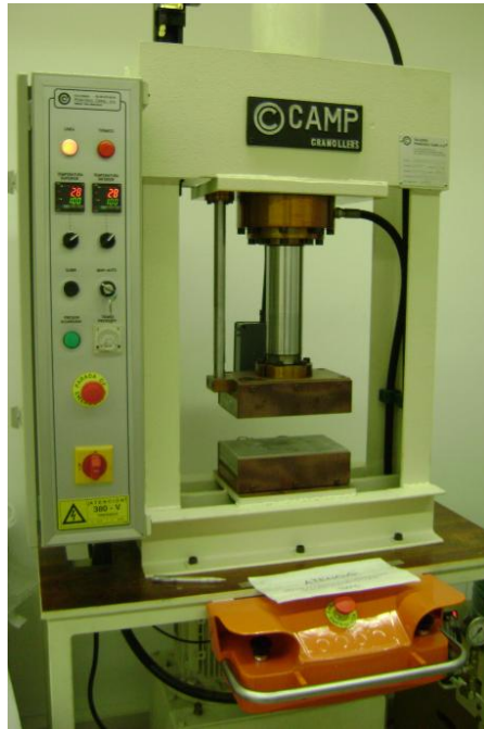
FIGURA 4.13. Prensa hidráulica para a laminação das cerâmicas.
