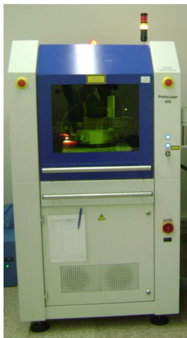
FIGURA 4.12. Equipamento a laser para o corte das cerâmicas verdes.
