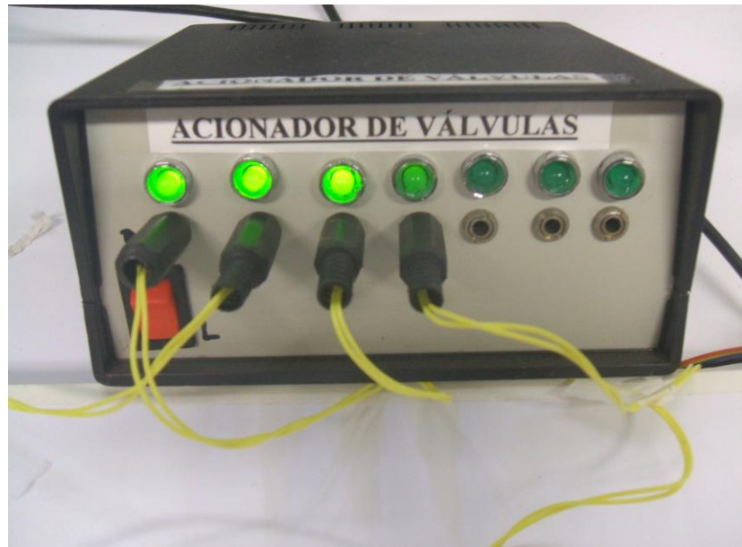
FIGURA 4.8. Acionador de válvulas com 4 destas sendo acionadas simultaneamente. Um total de 7 válvulas podem ser acionadas.
