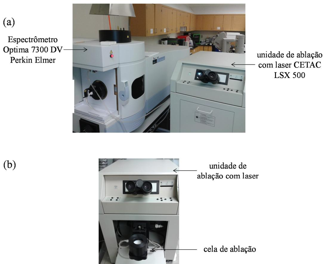
FIGURA 15 - (a) Imagem do sistema LA-ICP OES e (b) visão da cela de ablação.
