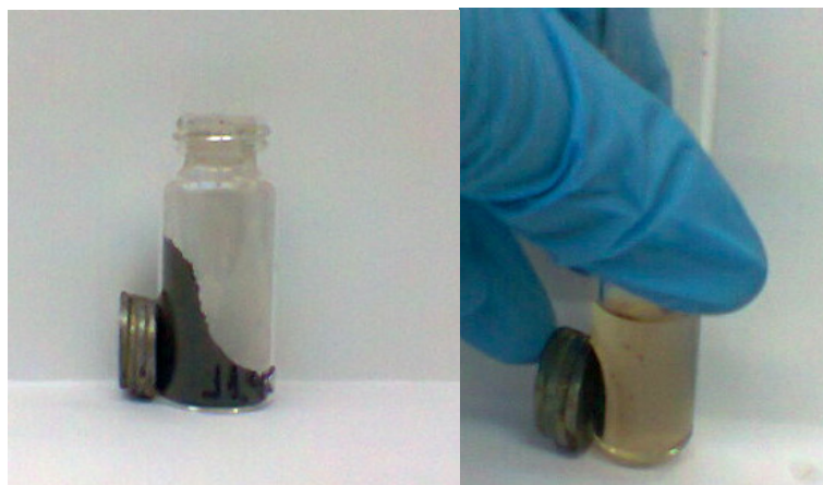
FIGURA 1.3 - Separação por aproximação de um magneto das nanopartículas magnéticas.
