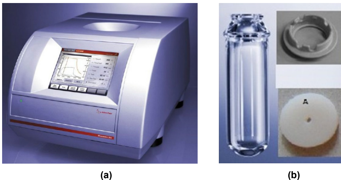
FIGURA 3.1 - Fotos do (a) reator de micro-ondas modelo Monowave 300 da Anton Paar e (b) frasco de reação de boro-silicato, tampa de encaixe e septo de silicone revestido com Teflon ® .
