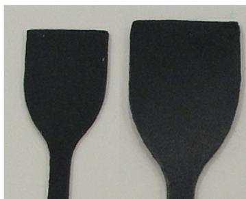
FIGURA 16 – Corpo de prova da amostra de borracha natural: antes (esquerda) e após a exposição (direita) à mistura de combustíveis DB20.
