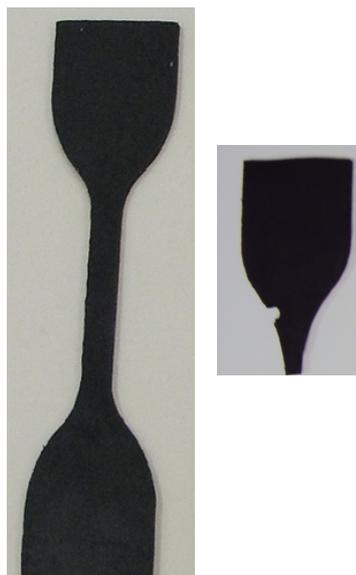
FIGURA 14 – Borracha comercial fornecida (esquerda) e corte (direita) inserido nos balões para a realização dos ensaios de exposição.
