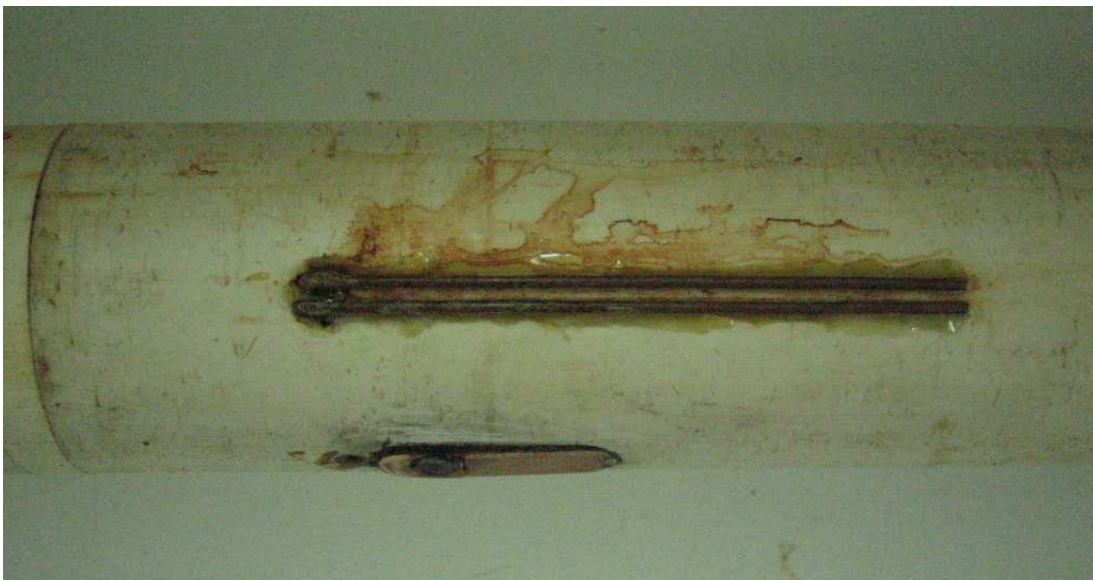
FIGURA 4.14. Foto da antena de transmissão para determinação da umidade por TDR formada por duas hastes paralelas de cobre.
