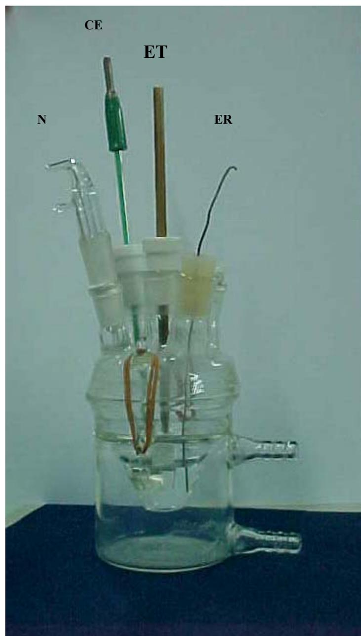
FIGURA 2.1 – Células electroquímica utilizada: ET= eletrodo de trabalho –  $\text{Nb}_2\text{O}_5$ / ITO/ vidro, ER= eletrodo de referência – fio de prata, CE= contra eletrodo – placa de platina e N= entrada para  $\text{N}_2$ .
