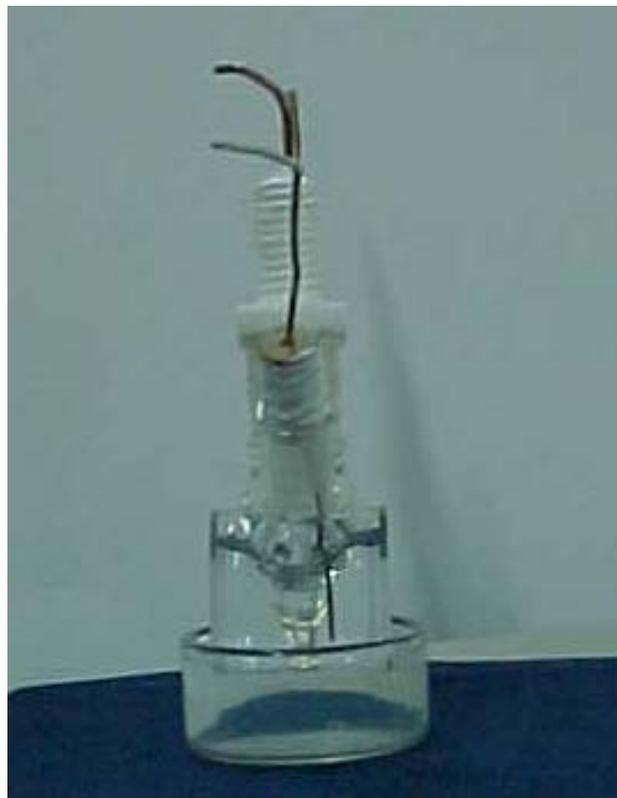
FIGURA 2.2 – Células eletroquímica utilizada: ET= eletrodo de trabalho –  $\text{Nb}_2\text{O}_5$ / ITO/ vidro, ER= eletrodo de referência – fio de prata e CE= contra eletrodo – placa de platina.
