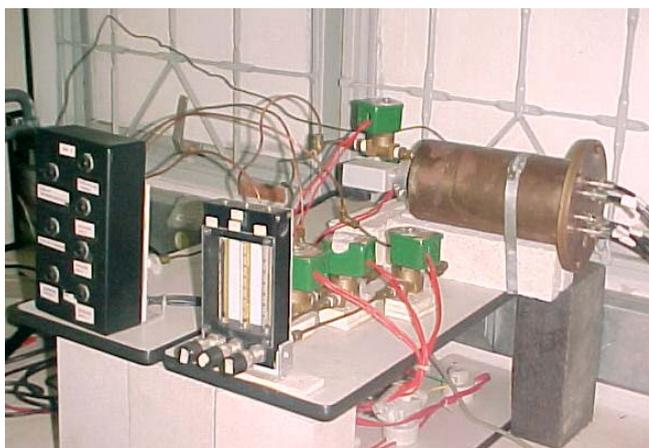
FIGURA 2.11. Sistema utilizado para a determinação das propriedades sensoras.
