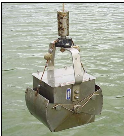
FIGURA 6 - Draga Birge-Ekman utilizada na coleta de sedimentos superficiais em Ibirité.
