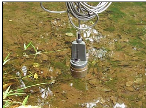
FIGURA 7 - Multi-eletrodo utilizado nas determinações físico-químicas in situ na coluna d'água da Represa de Ibirité e tributários.
