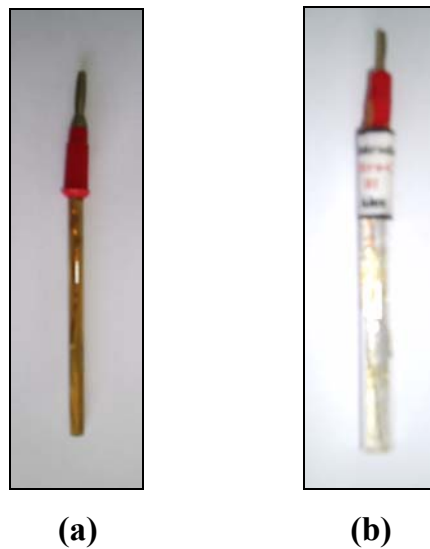
Figura 17: Fotografia dos eletrodos de trabalho utilizados ( \phi = 50,0 \mu\text{m} ). Eletrodo de fibra de carbono embutido em resina de poliéster (a), eletrodo de fibra de carbono embutido em araldite (b).
