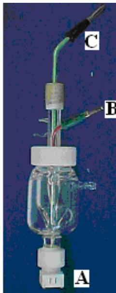
FIGURA 2.3: Célula eletroquímica utilizada para as medidas com a MECQ. (A) eletrodo de trabalho, (B) contra eletrodo, (C) eletrodo de referência.
