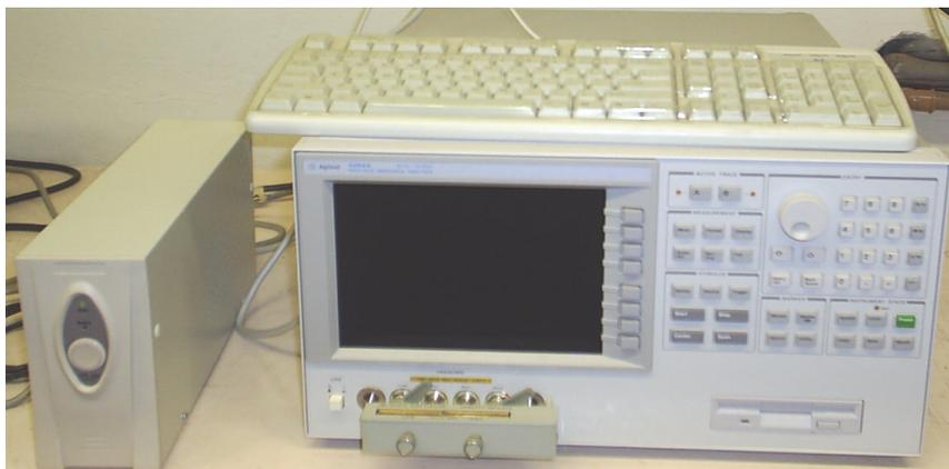
FIGURA 3.5. Analisador de impedância de precisão Agilent modelo 4294 A.
