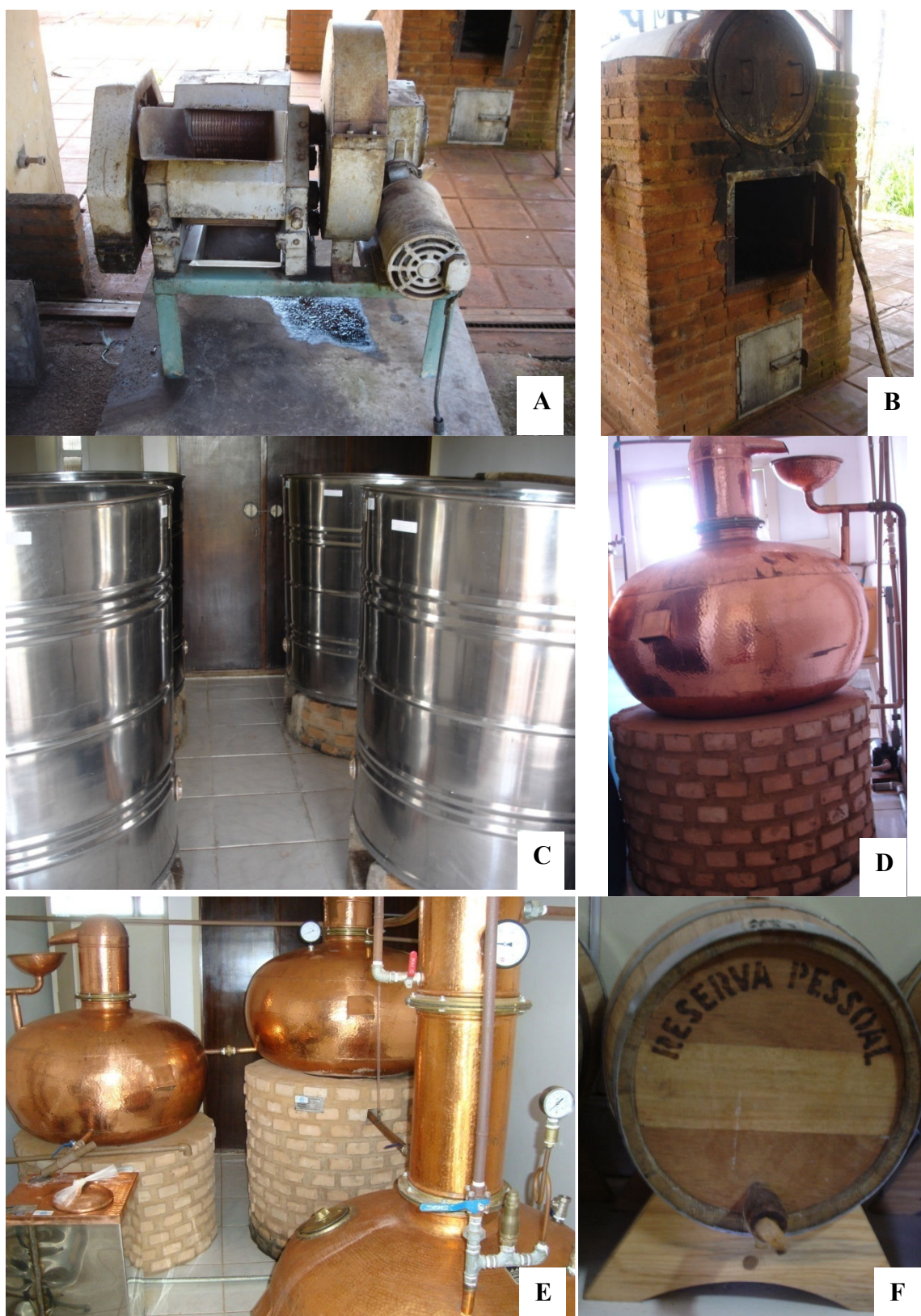
Figura 2. Aspecto do Laboratório de Agricultura Orgânica e Alimentos Orgânicos (LAO), CCA/UFSCar, onde a cachaça orgânica foi produzida. A. Moenda; B. Caldeira; C. Dornas de fermentação; D. Alambique tipo cebolão; E. Alambiques e pré-aquecedor; F. Tonel para envelhecimento da cachaça.
