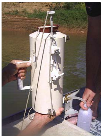
FIGURA 5.1- Garrafa Van Dorn utilizada na coleta de água no presente projeto.
