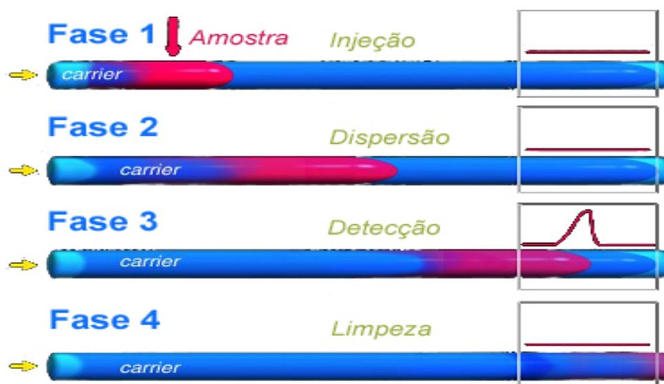
Figura 2.4: Base da Análise em fluxo (modificado de [www.flowinjection.com](http://www.flowinjection.com))
