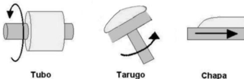
Figura 2.7 – Ilustração dos diferentes tipos de substrato e as possíveis formas de depósitos: a) tubo; b) tarugo e c) chapa.
