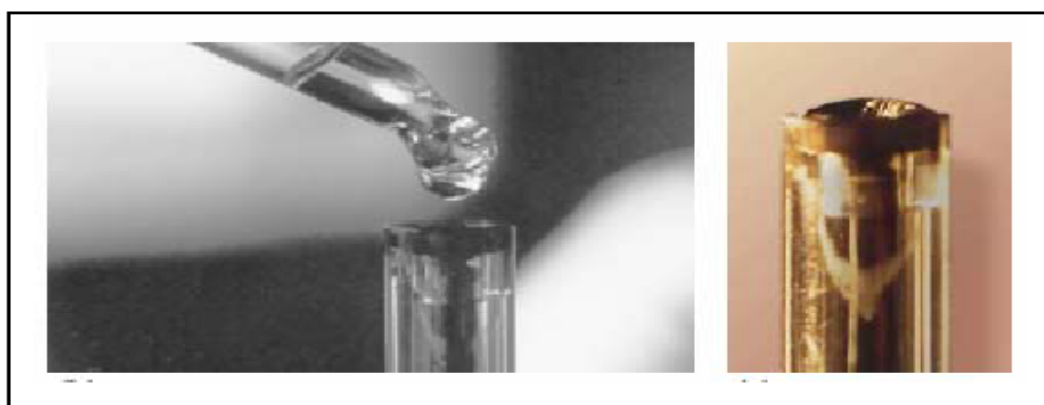
FIGURA 5.2: Detalhes da etapa de construção do eletrodo. Esquerda: deposição da membrana gota a gota. Direita: gota de coquetel sensor depositada e deixada em repouso para evaporação do solvente (LEMOS, 2005).
