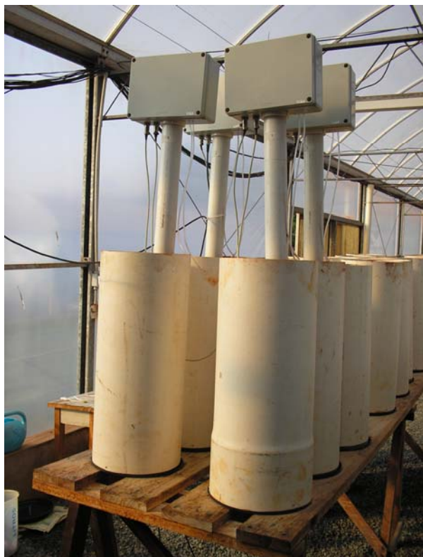
FIGURA 5.7 - Sondas instaladas nos vasos, no experimento montado em casa de vegetação.
