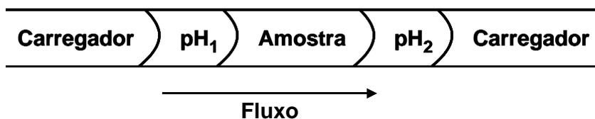
Figura 3.2.1 - Representação da formação de gradiente de pH em FA. Os segmentos  $\text{pH}_1$  e  $\text{pH}_2$  representam soluções com diferentes valores de pH.
