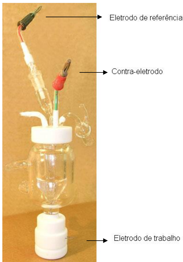
FIGURA 2.10 – Célula eletroquímica utilizada para as medidas eletroquímicas simultâneas com as medidas de MECQ.
