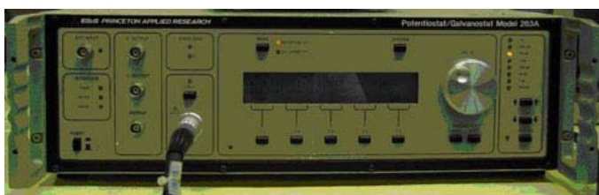
FIGURA 2.14 – Potenciostato/Galvanostato da EG & G PARC modelo 263 e Microbalança de cristal de quartzo SEIKO EG & G modelo QCA917.
