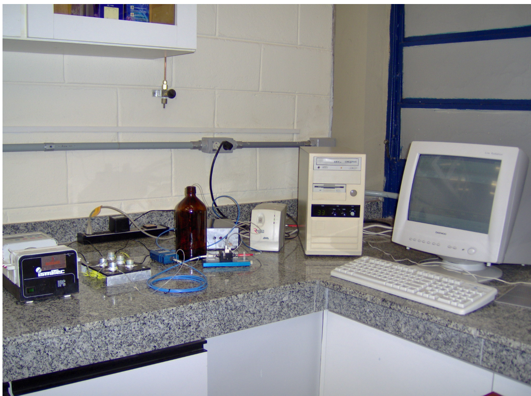
Figura 3.9 Fotografia do sistema em fluxo, proposto para a determinação de hipoclorito em alvejantes.
