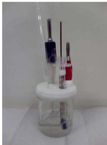
FIGURA 9: Célula eletroquímica utilizada nas análises voltamétricas.
