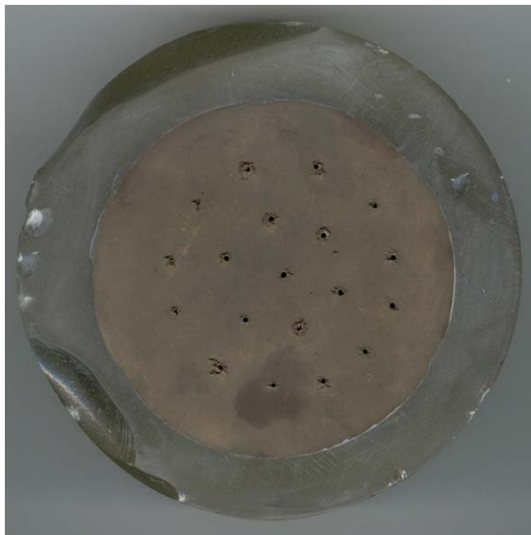
Figura 3.8 Foto do Eletrodo Poroso Ideal com os furos dêem posições simétricas; 1 no centro , 6 em r_1 e 12 em r_2 sendo 2r_1 = r_2 . r_1 = 1,1 cm.
