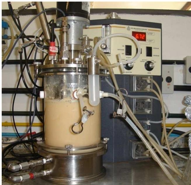
**Figura 3.1** – Vista externa de um biorreator convencional tipo tanque agitado e aerado de bancada em operação
