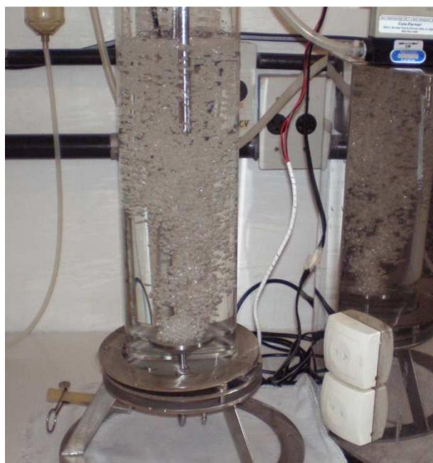
**Figura 3.6** - Biorreator coluna de bolhas operando com água destilada
