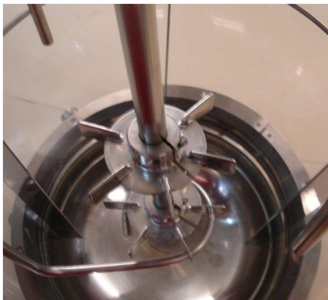
**Figura 3.2** – Vista interna de um biorreator convencional tipo tanque agitado e aerado com dois impelidores tipo turbina de seis pás planas (modelo Rushton)
