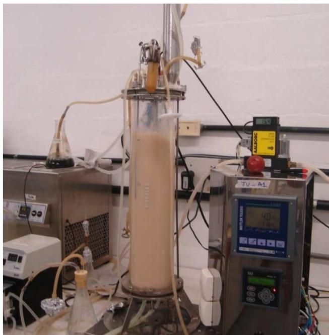
**Figura 3.3** – Vista externa de um biorreator airlift de bancada em operação
