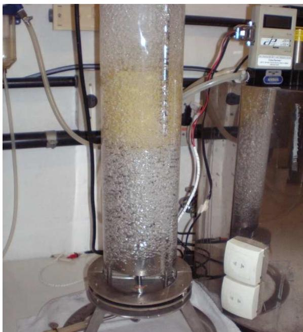
**Figura 3.5** – Biorreator airlift de cilindros concêntricos operando com água destilada
