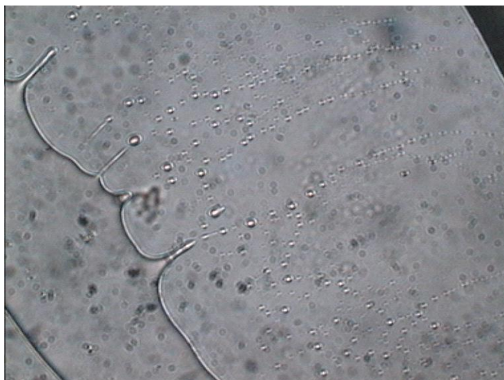
Figura D.2 – Fotomicrografia da fibra de SAN na matriz de PMMA (aumento 400x)
