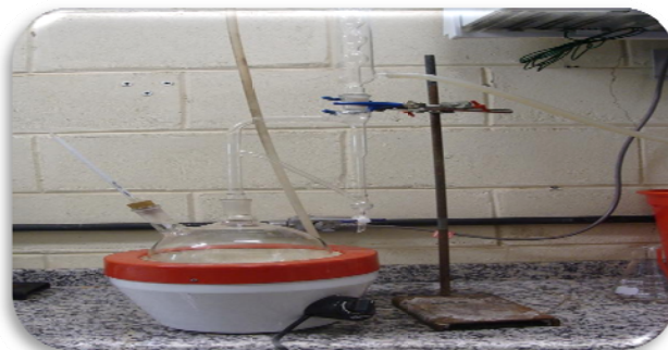
Figura 3-2 - Sistema de hidrodestilação utilizando o aparelho de Clevenger.
