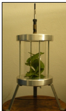
Figura 3.2 - Extração dos voláteis das folhas de A. graveolens por Headspace.
