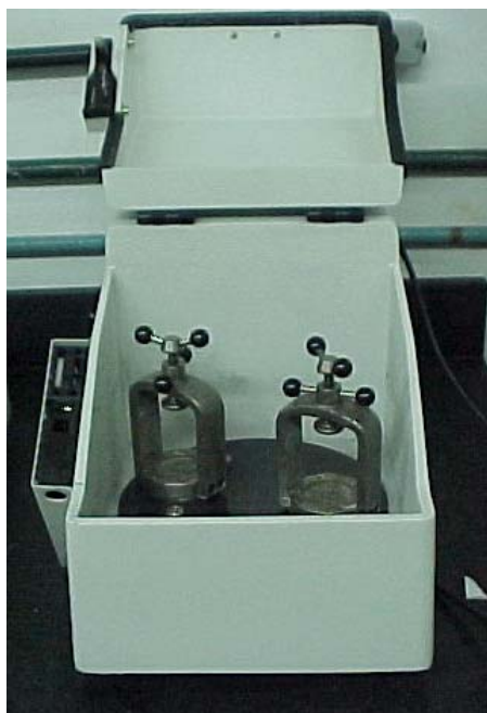
Figura 3.3 - Moinho planetário (P7), instalado no Laboratório de Cerâmicas Eletrônicas do DEMa.
