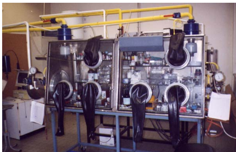
Figura 3.2 - Glover-Box utilizada no LTPCM, para a manipulação dos compósitos a base de Mg.
