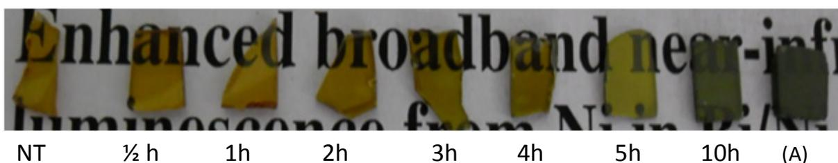
FIGURA 5.16 - Fotografia da amostra ATC-1Ni, tratada termicamente a  $470^{\circ}C$  em diferentes períodos, evidenciando a transparência do material.
